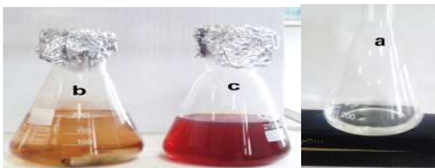
شکل ۸- شکل a, b, c به ترتیب، محلول نیترات نقره ۱ میلی مولار، مخلوط عصاره با محلول نیترات نقره و محلول نانو ذرات تهیه شده
