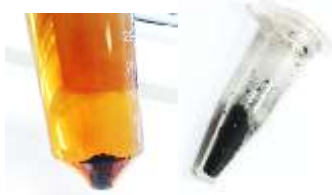
شکل ۱۰- سمت چپ نانو ذرات نقره تهیه شده بعد از سانتریفیوژ و سمت راست نانو ذرات خشک شده
