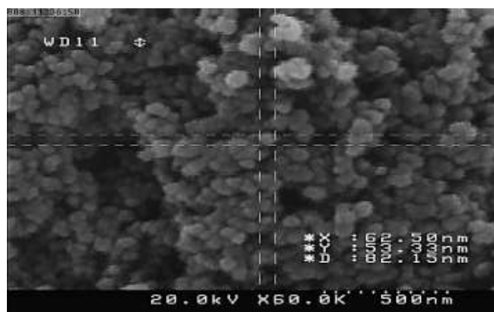
شکل ۱۴- تصویر میکروسکوپ روبشی نشر میدانی از نانو ذرات نقره، ۷۲ ساعت بعد از سنتز
