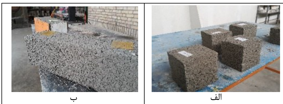
شکل ۴. نمونه های ساخته شده از اساس سیمانی جهت انجام آزمایش مقاومت فشاری و خمشی در این تحقیق در جدول ۱ نیز از نتایج آزمایش های انجام شده روی مصالح ارائه شده است.
