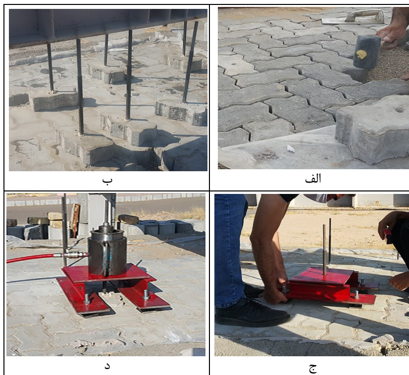
شکل ۱۳. مراحل انجام آزمایش بیرون کشیدگی بلوک
