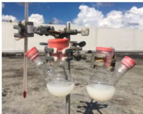
شکل ۲. سامانه انجام واکنش تحت تابش نور طبیعی خورشید
