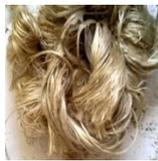
Fig. 5. Raw jute fiber
