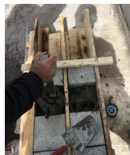
شکل ۱- مراحل ساخت و نحوه قرارگیری نمونه‌ها در دستگاه اعمال چرخه ذوب و انجماد
