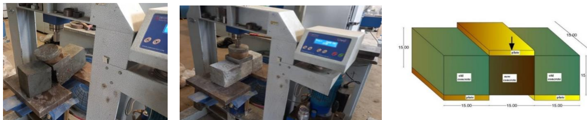
شکل ۲- نحوه اتصال بتن‌های جدید و قدیم و مراحل انجام آزمایش مقاومت برشی
