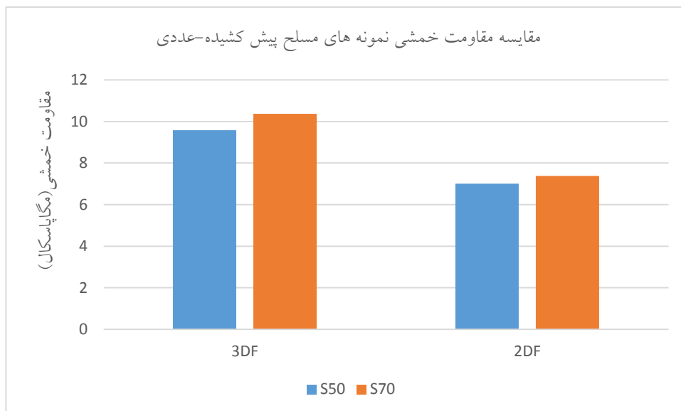
شکل ۱۷. مقایسه مقاومت خمشی نمونه‌های مسلح پیش‌کشیده-عددی
