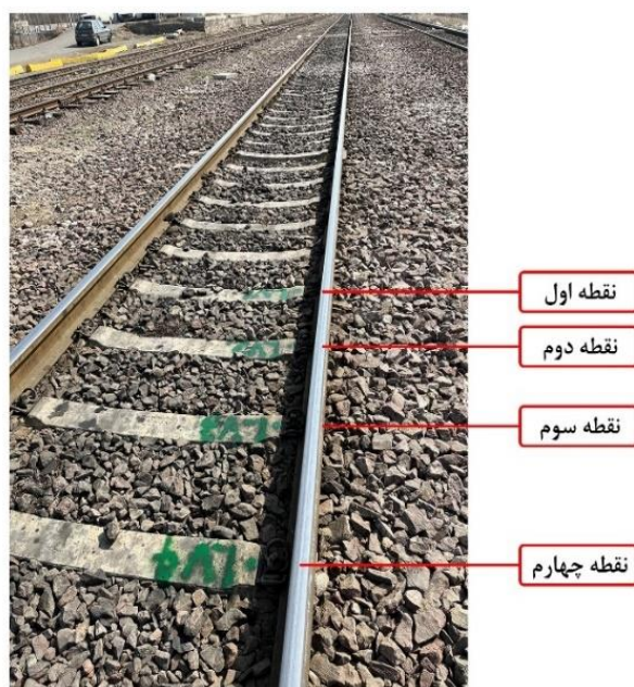
شکل ۵. چهار تراورس مشخص شده برای اندازه‌گیری سختی قائم خط آهن بالاستی
