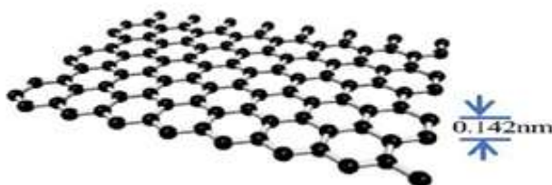
شکل ۱- ساختار گرافن و پیوند کووالانسی بین لایه های گرافن نشان داده شده است.
